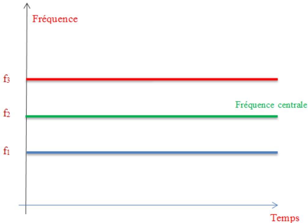
**Figure II.3:** Principe d'un multiplexage en longueurs d'onde (WDM)
