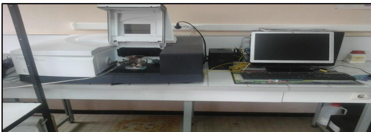
**Figure5:** Spectroscopie infrarouge à Transformée de Fourier (IRTF)
