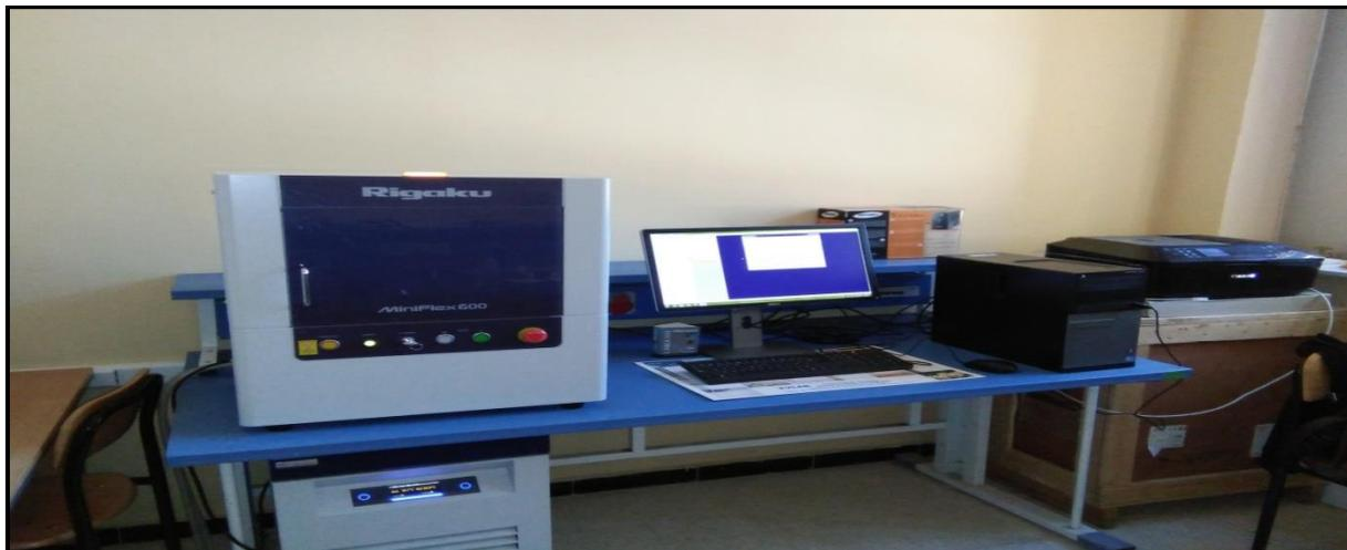
**Figure 1:** Diffractomètre des rayons X (DRX) Rigaku Mini Flex 600
