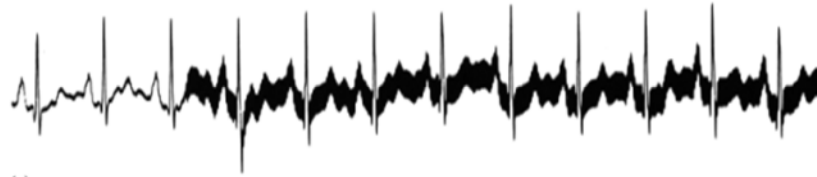
Figure II .12 Exemple d'ECG présentant des interférences 50Hz
