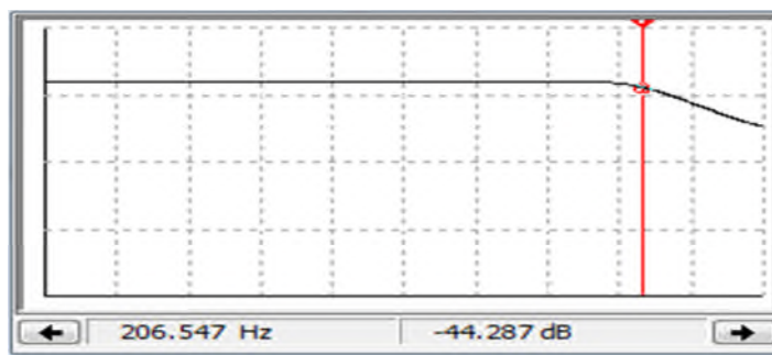
Figure II .11 Réponse fréquentiel du filtre passe haut fc=206.547Hz
