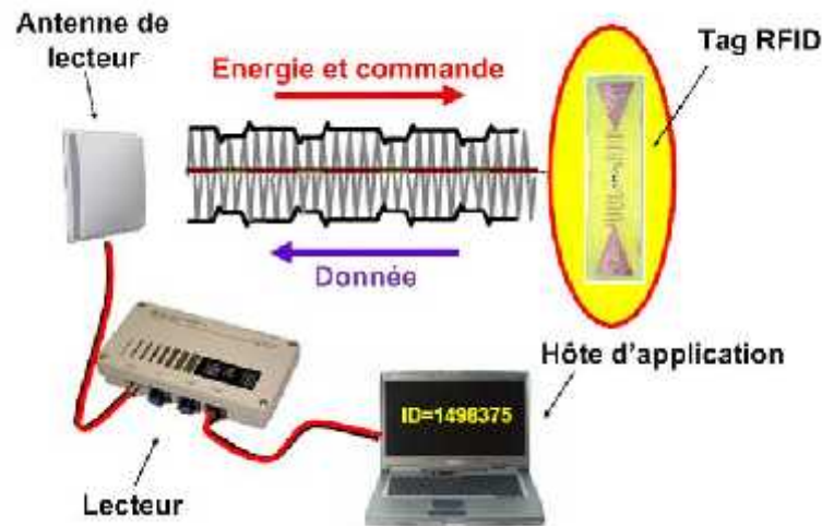
Figure 1.3: Éléments d'un système RFID [2].
