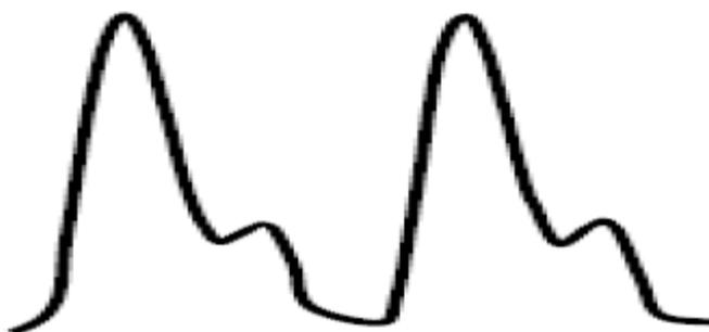
Figure 1.16 La forme de signal PPG.
