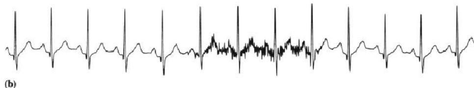
**Figure(II.15)** Interférences d'origine électromyographique
