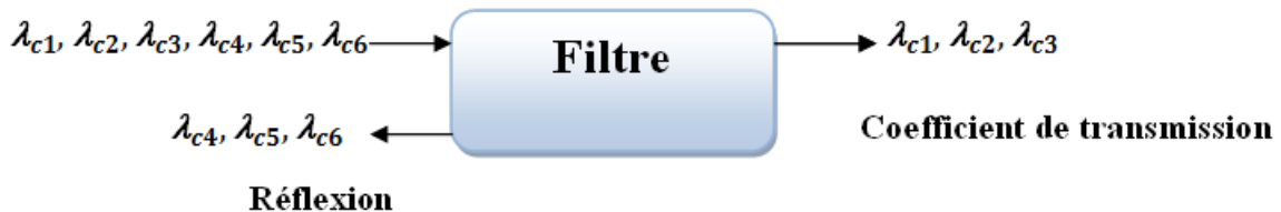
Figure III-15: Schéma de fonctionnement de base d'un filtre
