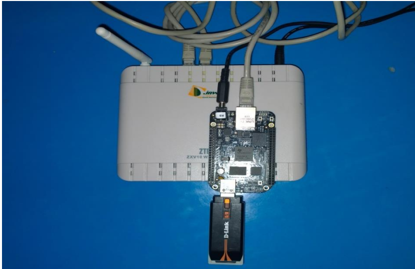
Figure IV.14. L'installation de BBB avec un Modem Routeur WIFI.
