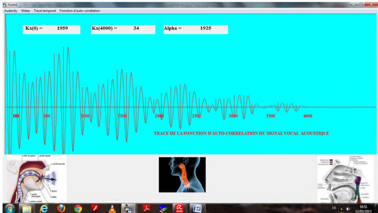
Figure 27 : Capture d'écran des pics et le calcul du coefficient d'atténuation de la fonction d'auto-corrélation du signal vocal d'un sujet sain.
