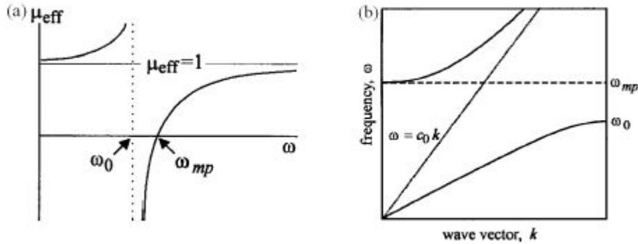
Fig.I.6 :(a) la perméabilité magnétique effectif d'un milieu de MNG. (b) diagramme de dispersion d'un milieu de MNG. La transmission est inhibée dans la gamme de fréquence  $\omega_0 - \omega_{mp}$ , où est  $\mu_{\text{eff}}$  négatif. Chiffres extraits de[3]
