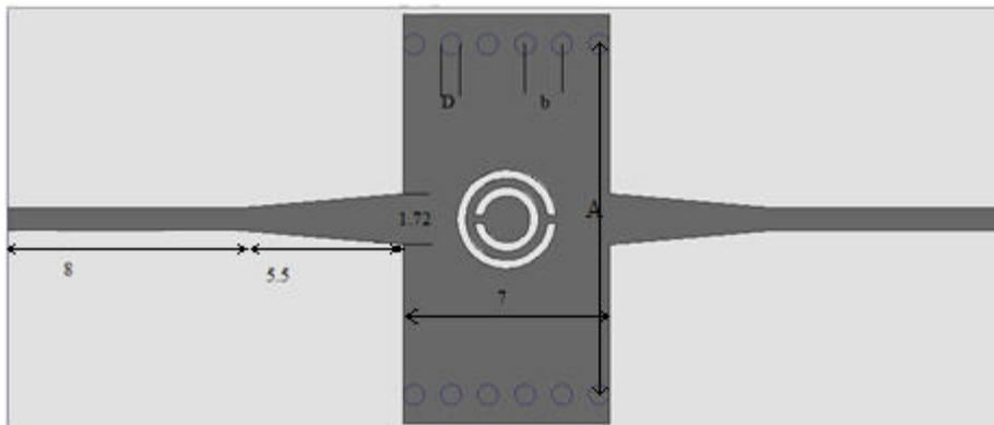
Figure IV.3 : SIW avec une cellule CSRR.
