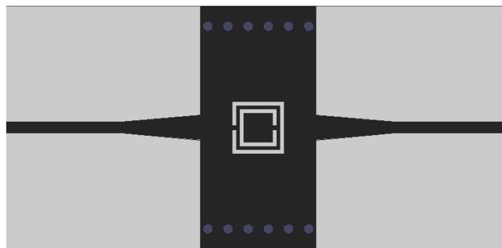
Figure VI.7 : SIW avec une cellule CSRR carrée.
