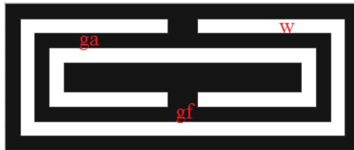
Figure III.19. Configuration de la cellule CSRR rectangulaire.
