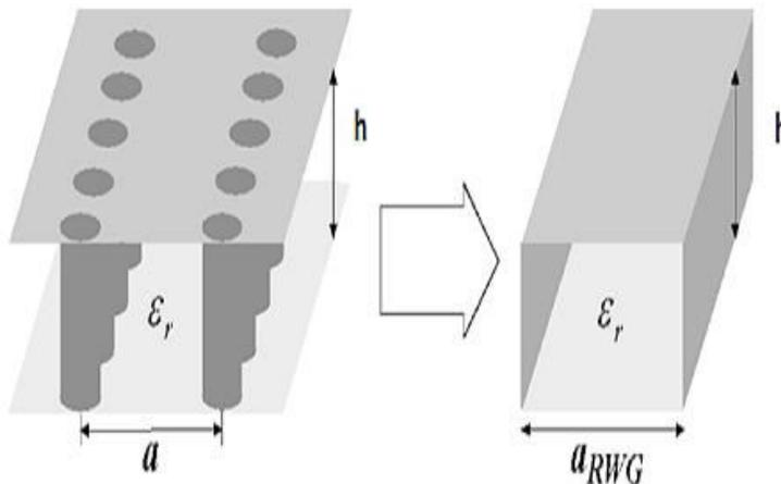
Figure II.5 : SIW et guide d'ondes rectangulaire équivalent.
