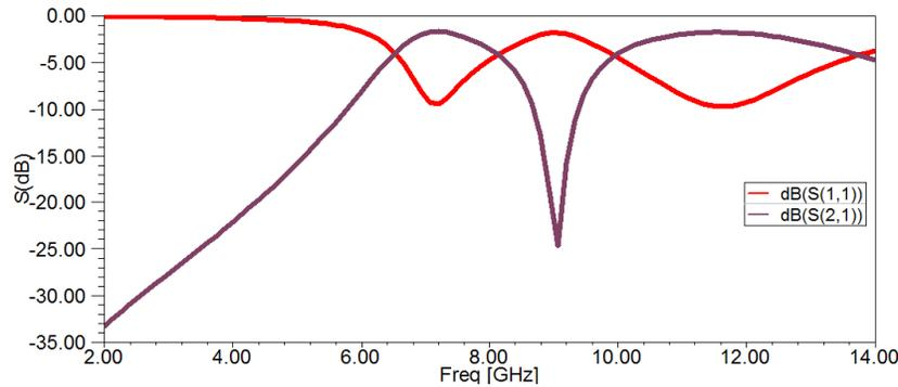
Figure IV.14: Résultat de simulation des paramètres S.
