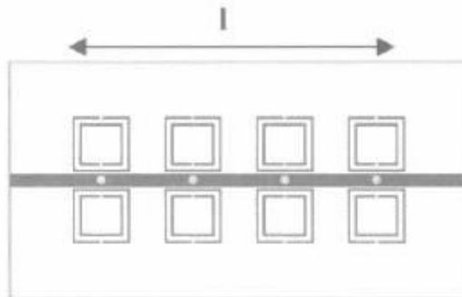
Figure I. 17. Plan d'une structure LH MMT en microruban.
