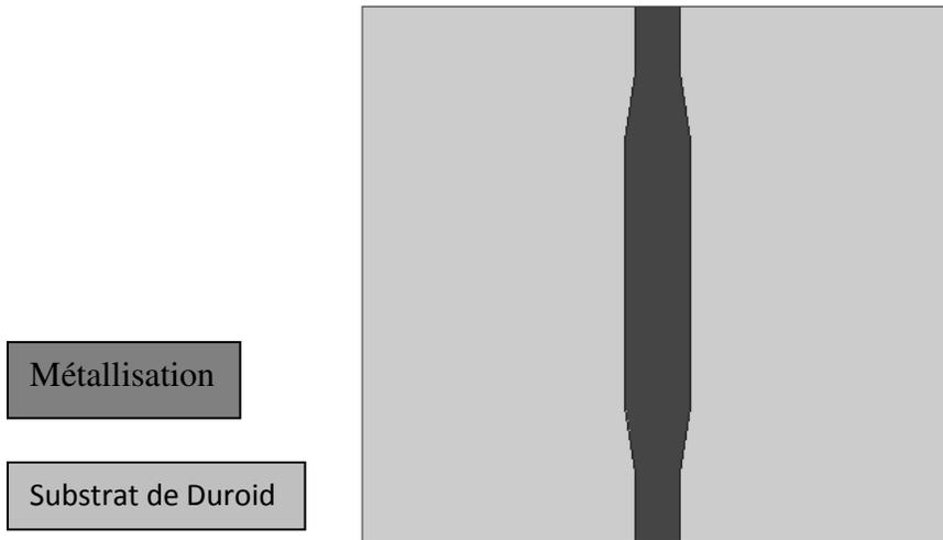
Figure III.25 : Configuration d'une ligne microruban 50Ω avec taper.
