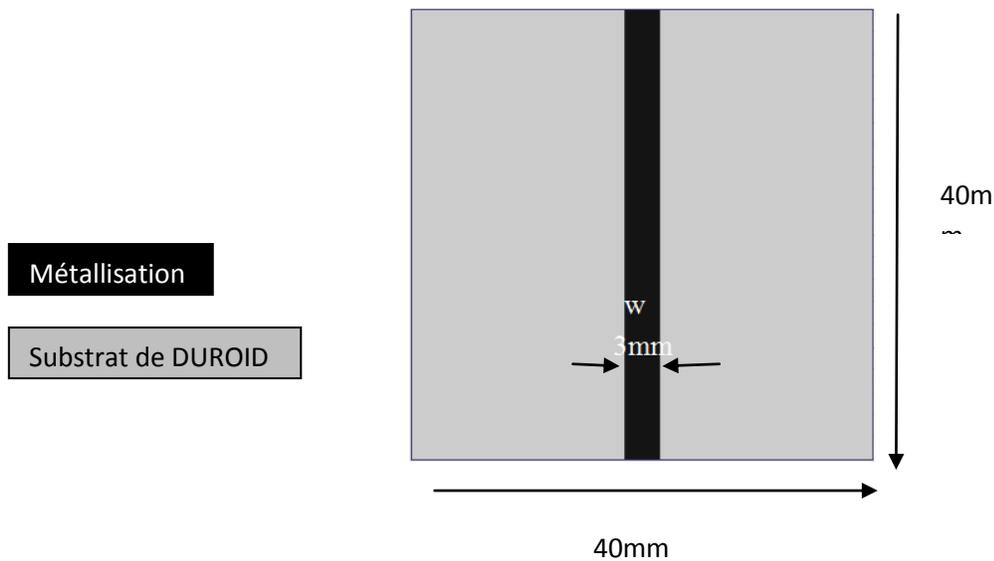
Figure III.12 : Configuration d'une ligne micro-ruban 50Ω
