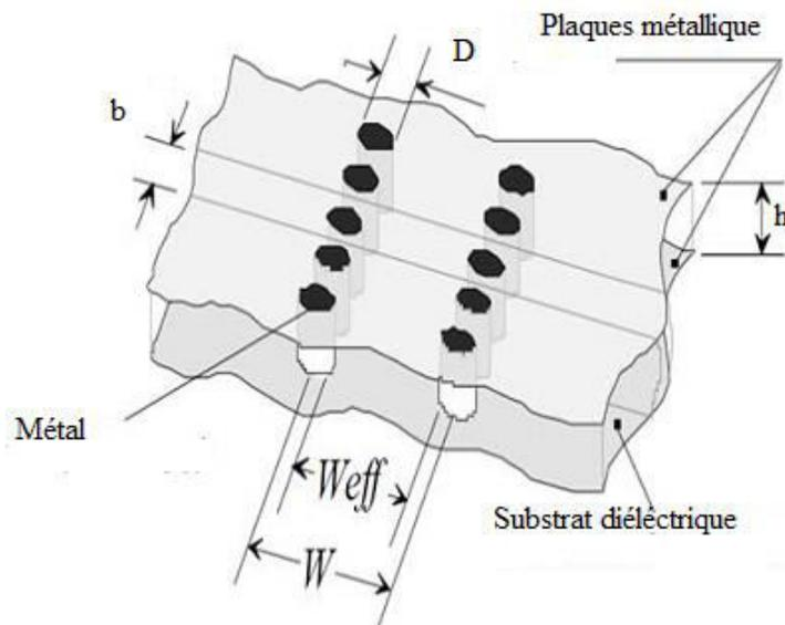
Figure II.4 : Structure SIW avec ces paramètres de conception.
