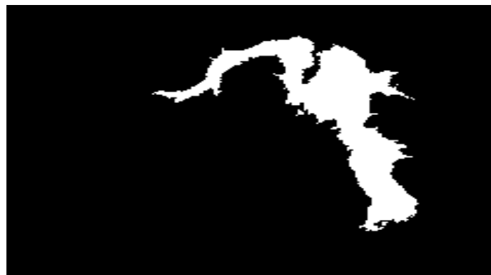
Figure IV.9. Segmentation d'image avec élimination des pixels isolés.
