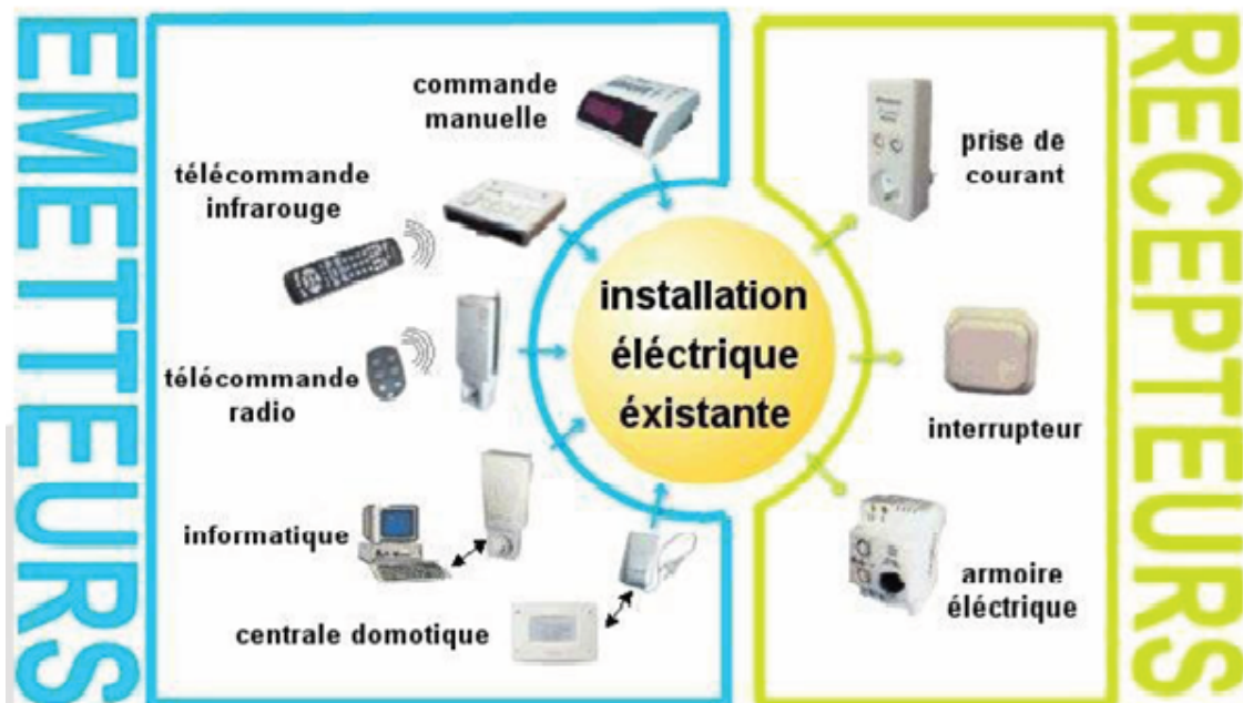
FIGURE II.5 – Exemple d'une installation CPL
