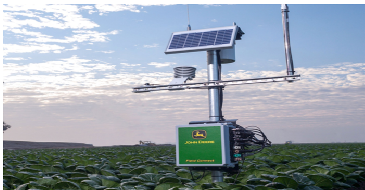
FIGURE I.8 – Capteur de température et de la vitesse du vent et taux d'humidité
