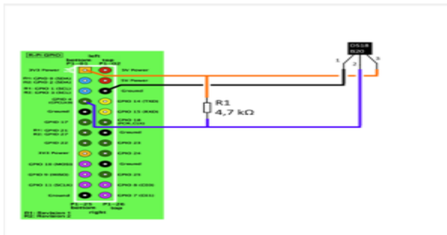
FIGURE IV.13 – Câblage de la sonde DS18B20 avec Raspberry
