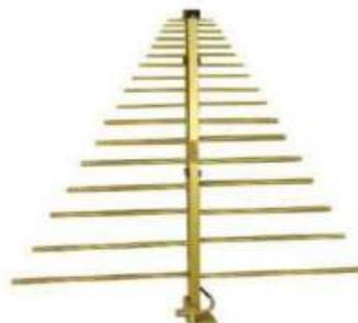
Figure I.11 : Réalisation pratique d'une antenne LPDA [I.1].
