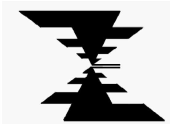
Figure I.10 : Antenne spirale à forme trapézoïdale.
