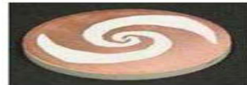
**Figure I.6 :** Antenne spirale logarithmique.
