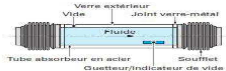
Figure 2.7: Structure d'un absorbeur
