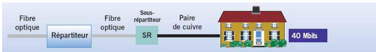
Figure II.3 : Structure d'un réseau FTTC/FTTCab.
