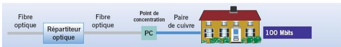
Figure II.2 : Structure d'un réseau FTTB.
