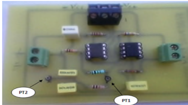
Figure 3.10 : Le circuit de mise en forme du signal détecté
