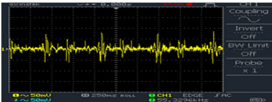
Figure 3.7 : Le signal PCG détecté à la sortie du filtre passe bas
