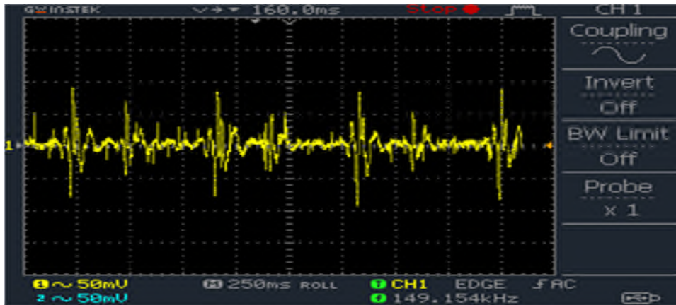
Figure 3.8 : L'allure du signal PCG obtenu en sortie générale après amplification et filtrage.
