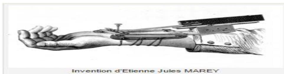
Figure 1.3 : Premier dispositif de mesure de la pression artérielle. [6]
