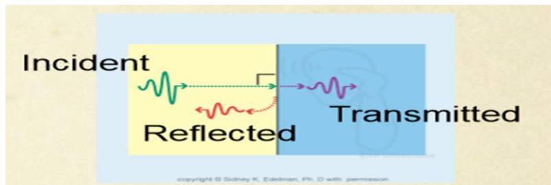
Figure I.9 : Phénomène de réflexion de l'onde ultrasonore.
