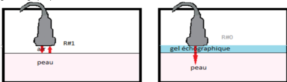
Figure I.6 : L'effet du gel échographique sur la transmission des ondes ultrasonores.
