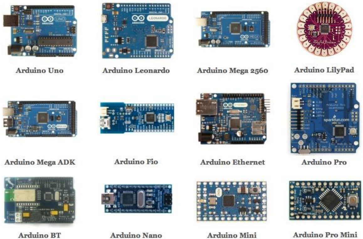
Figure 17: Différent types des cartes arduino [29]
