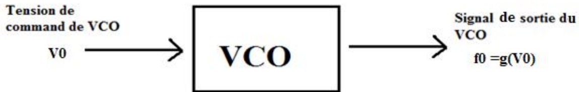
Figure 2 .25 : principe du VCO
