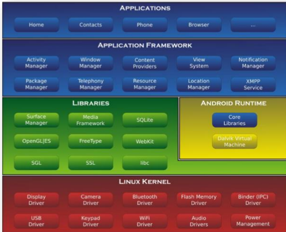
Figure III.12 : Les composants principaux de système d'exploitation Android
