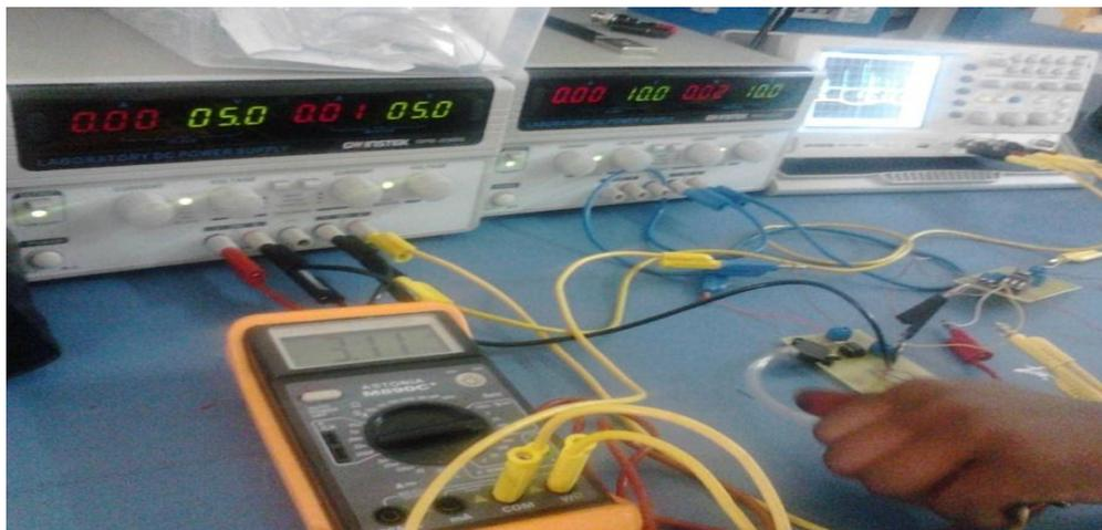
Figure 3.7 : Test de capteur MPX2100AP
