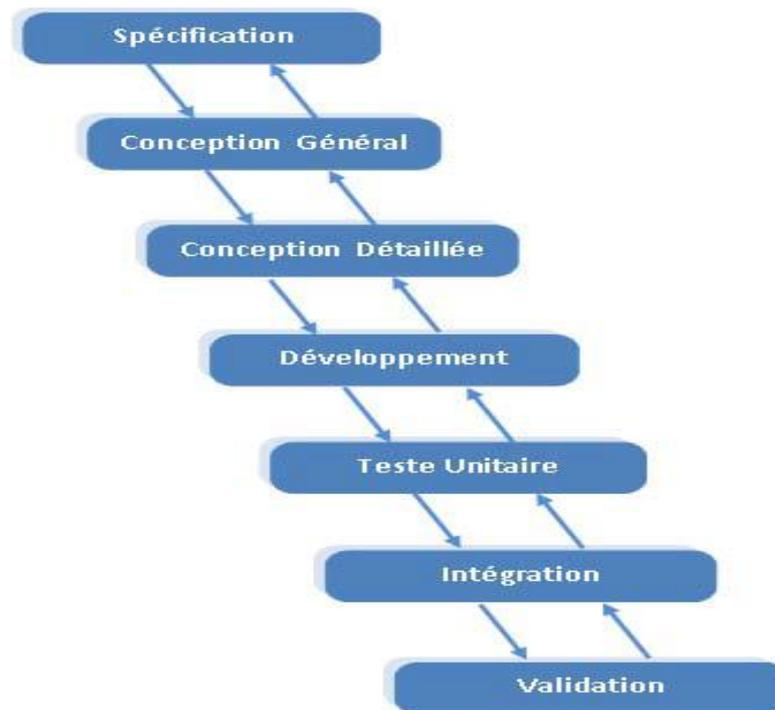
**Fig. III.10** : Modèle de cycle de vie en cascade [18]
