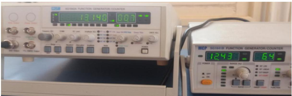
Figure (III.17) : la fixation de fréquence de la signale d'entre pour tester le circuit EEG réellement.
