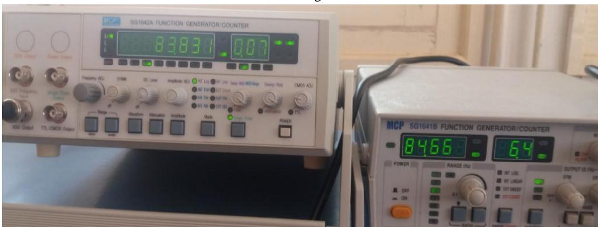
**Figure (III.2) : fixation de  $V_e$  par deux GBF.**
