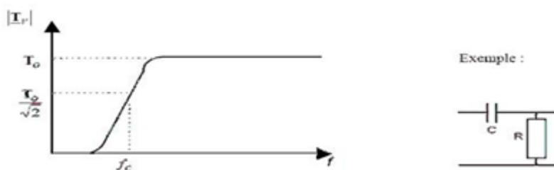
Figure (II.10): Courbe qui représente la réponse fréquentielle d'un filtre passe-haut
