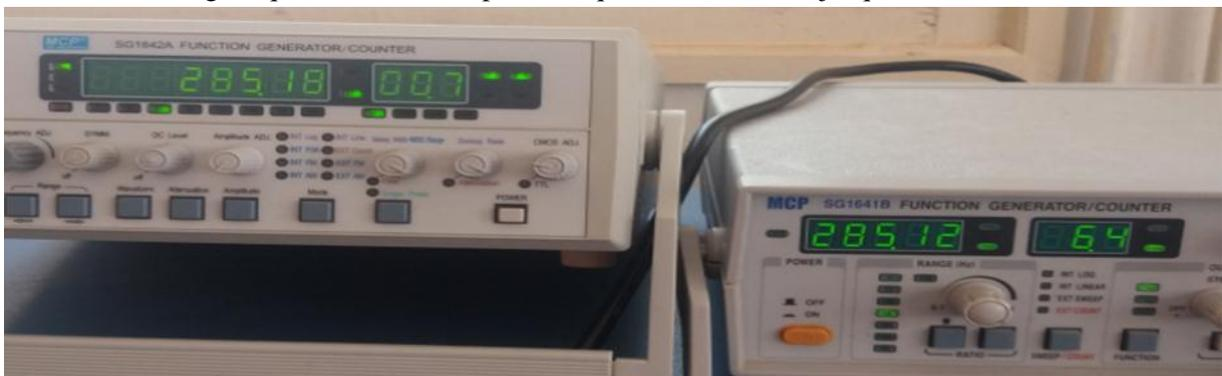
Figure (III.12) : la fixation de fréquence de l'entre pour tester la réponse de filtre EMG.
