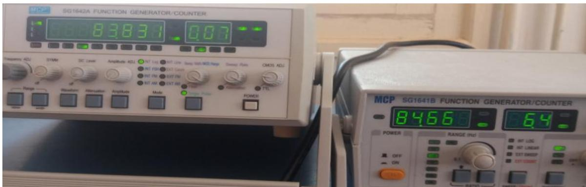
Figure (III.7) : la fixation de la fréquence d'entre pour tester le circuit d'ECG
