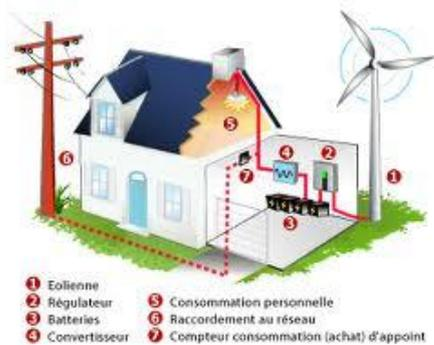
Energie produite à partir de la force du vent sur les pales d'une éolienne. Lorsque le vent se met à souffler, les forces qui s'appliquent sur les pales des hélices induisent la mise en rotation du rotor. L'énergie électrique ainsi produite peut être distribuée sur le réseau électrique grâce à un transformateur.
