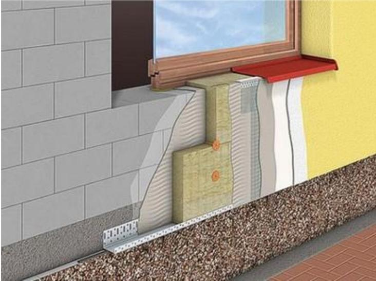
Figure 22 : vue axonometrique des composants des parois exterieurs
