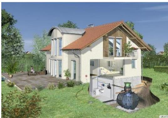
Figure 25 : détail technique pour récupérer l'eau de la pluie
