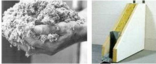
A gauche : cellulose en vrac ; à droite : panneau à base de cellulose et de lin
