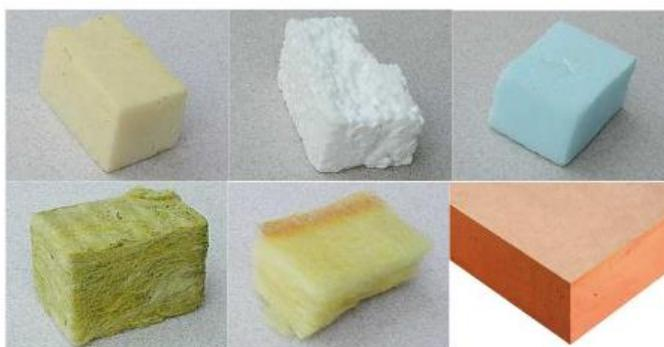
De gauche à droite : mousse de polyuréthane, mousse de polystyrène expansé, mousse de polystyrène extrudé, laine de roche, laine de verre, mousse résol (Sources : Energie + et [www.kingspan.be](http://www.kingspan.be))
