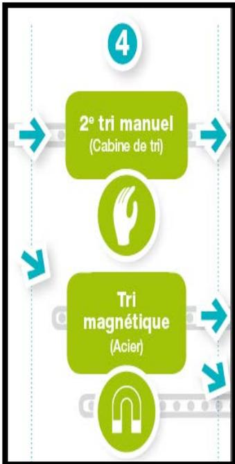
Le flux qui passe au niveau du séparateur magnétique contient des déchets en plastiques différents, en aluminium, en acier. Les déchets qui contiennent du fer sont attirés par l'aimant du séparateur magnétique. Ils sont donc séparés du reste. L'acier pourra ainsi être valorisé. Les autres déchets, plastiques et aluminium continuent leur chemin.
