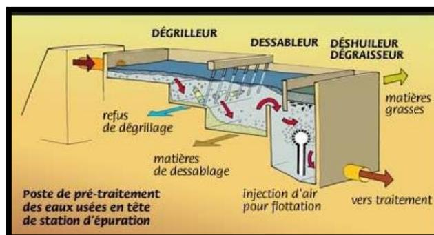
Figure 26 : les différentes étapes de traitements d'eau
