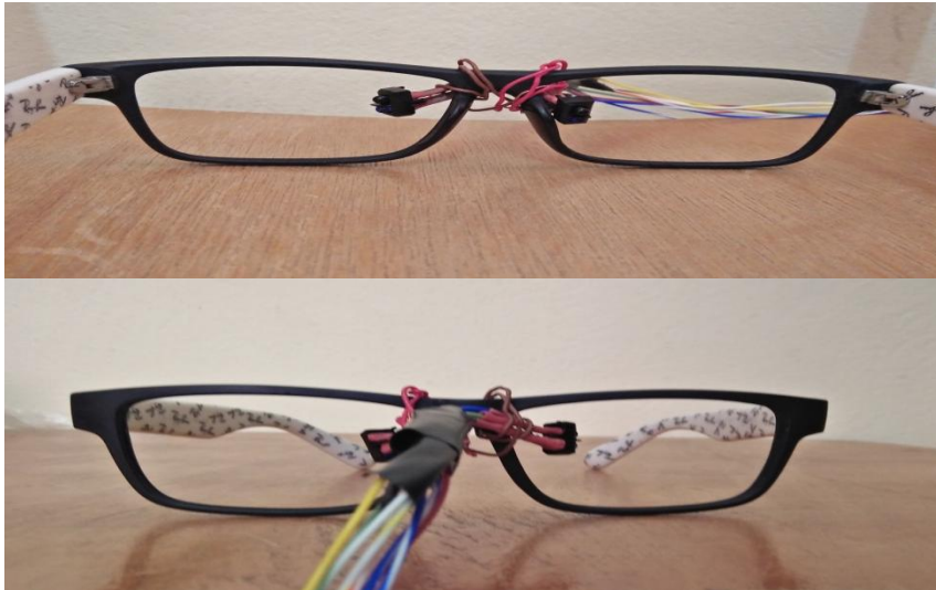
Figure III.20: l'emplacement des capteurs sur la monture de lunettes.
