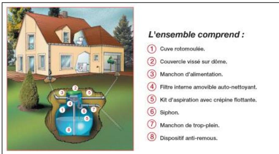
**Figure VI.22 : Schéma de récupération des eaux de pluie**
