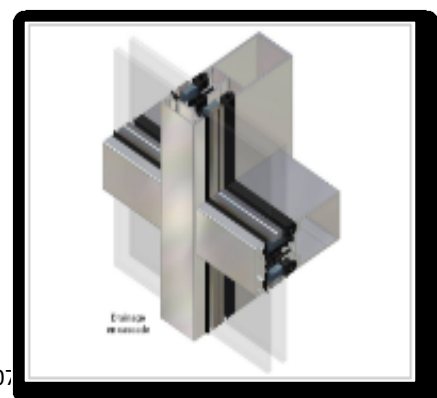
Figure 21. Détail d'un mur rideau.
