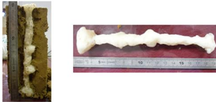
Figure 4.5 : Mesure du volume final du sol érodé.
