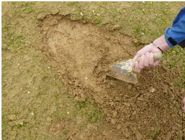
Photo 3.4 : Enlevage de la terre végétale dans la dige traité après 365 jours.
