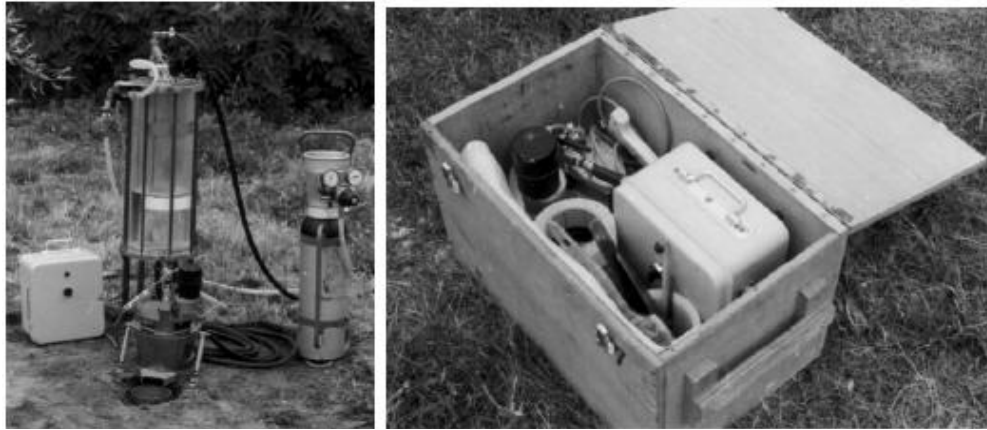
Figure 3.2 : Erodimètre à Jet Mobile LCPC (Hénensal et al., 1987).
