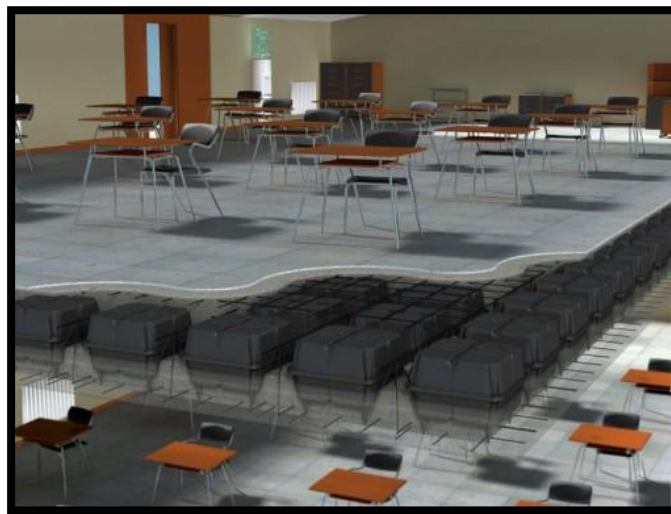
Figure 77 : le plancher à caissons 96
