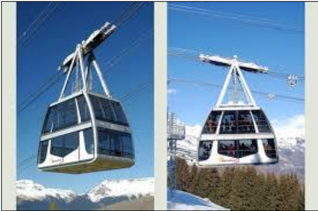
Figure 64. Téléphérique bi câble à va et vient avec vue panoramique 168
