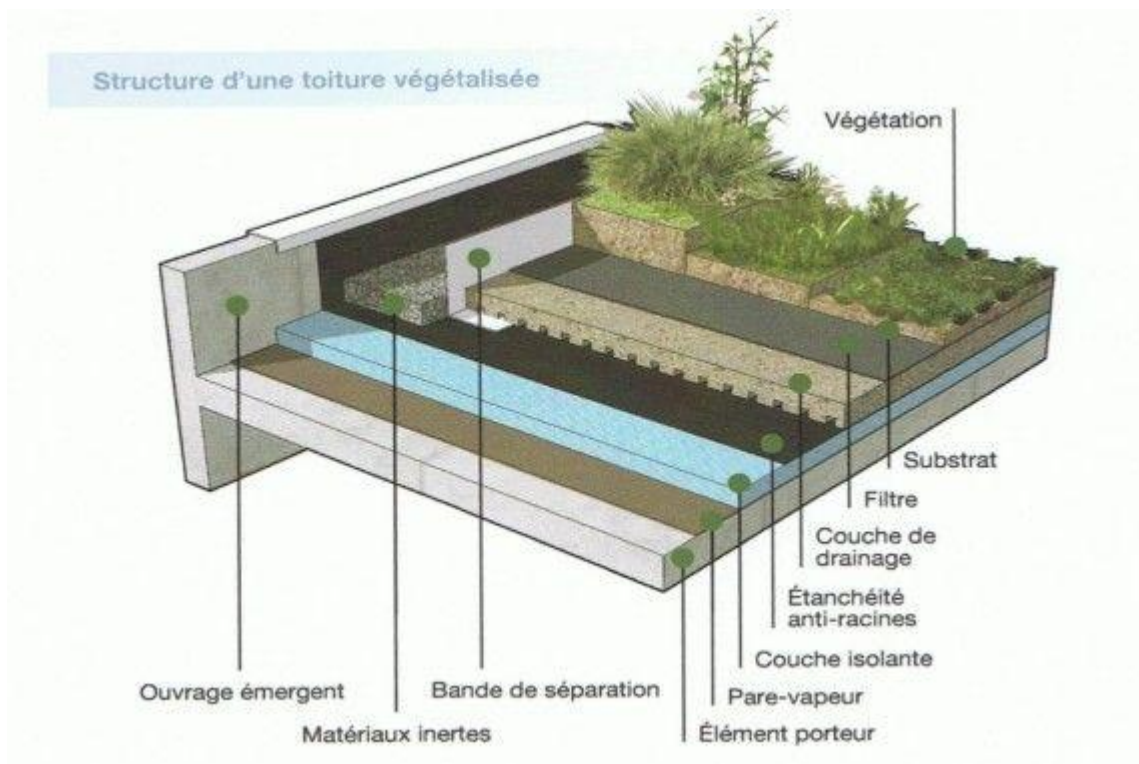
Figure 92: structure d'une toiture végétalisée
