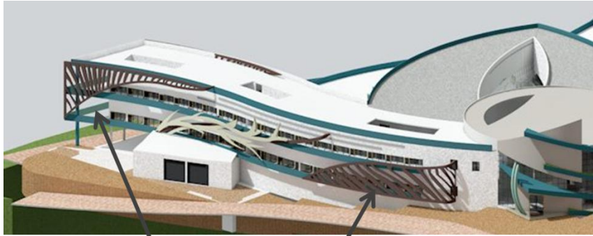
Des panneaux stratifiés (HPL - High Pressure Laminates)
