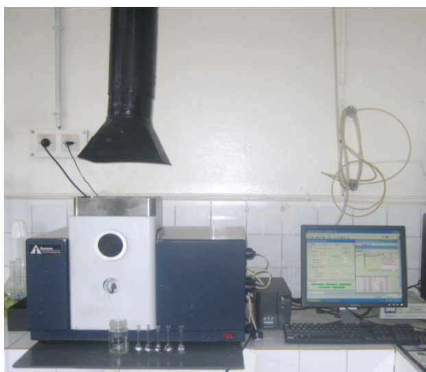
Figure III.3 : Spectrophotomètre d'absorption atomique à flamme (SAAF) de type AURORA AI.1200 (Photo Fella, 2010).
