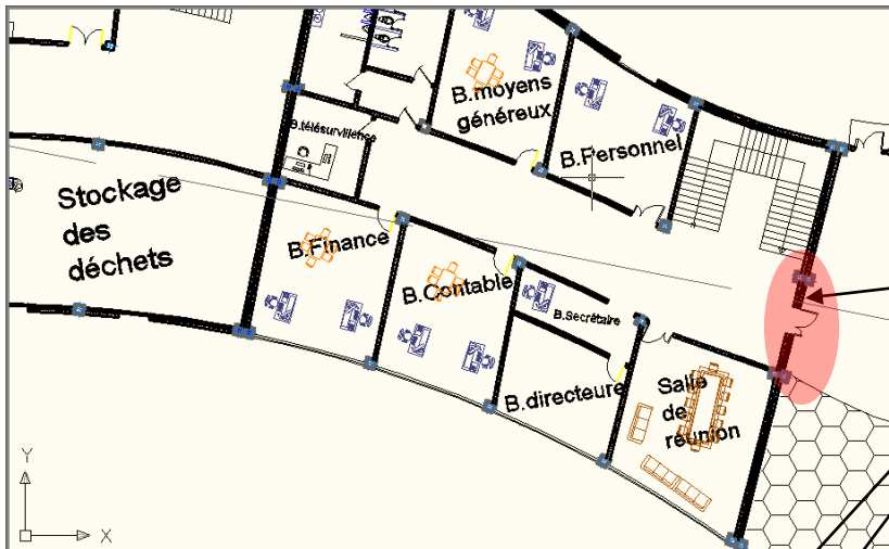
Figure 138: l'utilisation des serrures électronique dans le projet
