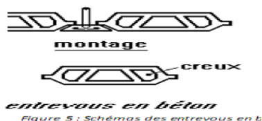
Figure 5 : Schémas des entrevous en B
