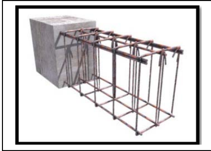
Figure40 : ferrailage d'une poutre
