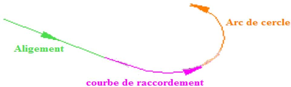
Figure2.1 : Les éléments de tracé en plan
