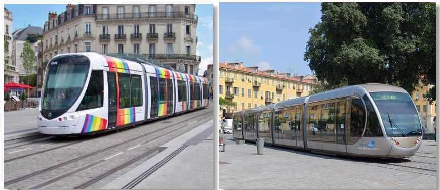
Figure 28: rame alimentée par batterie NiMH (tramway de Nice)
