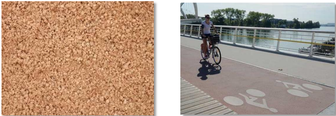
Figure 4: Sable stabilisé à usage : piste cyclable
