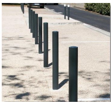
Figure 22 : Potelets et bornes « Classiques » Fonte grise, dimensions de 0,60 à 1,15 m
