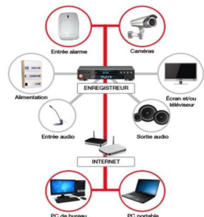
Figure 165:système de sécurité
