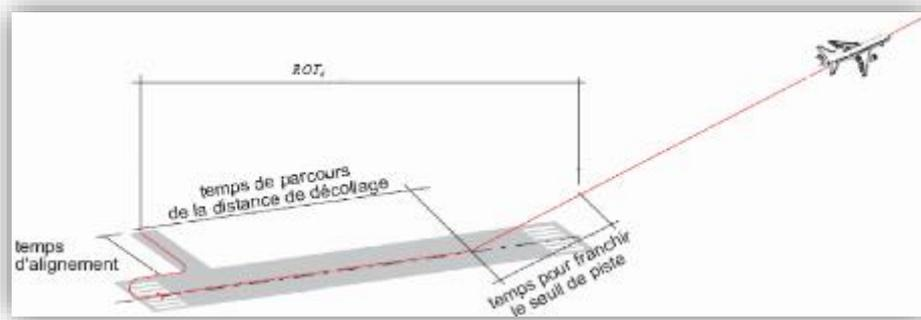
**Figure 68.** Schéma du circuit de décollage des avions<sup>18</sup>
