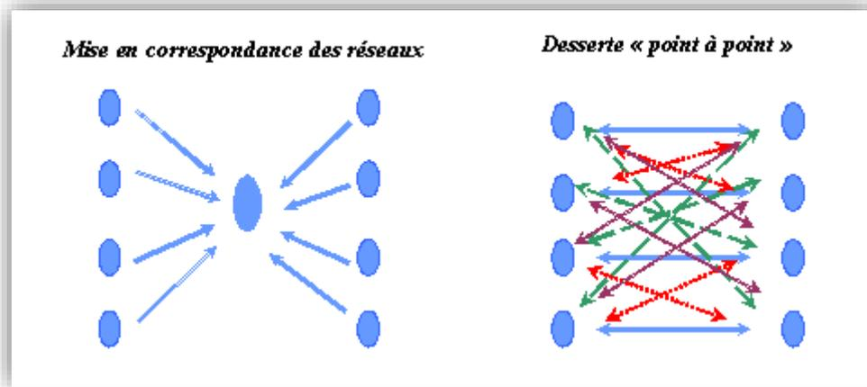
Figure 5. Schéma représentatif du système HUB par rapport au système simple<sup>2</sup>
