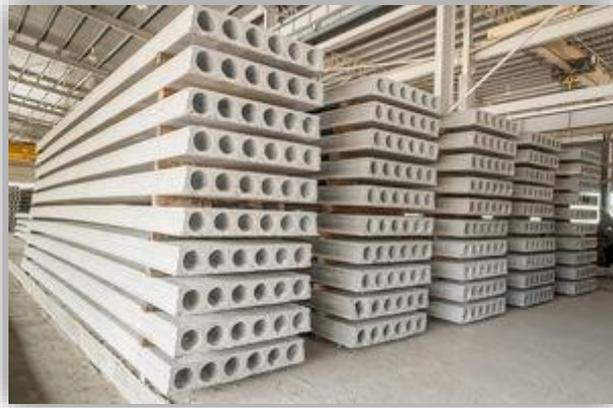
**Figure 93.** Photo des dalettes alvéolés à la préfabrication
