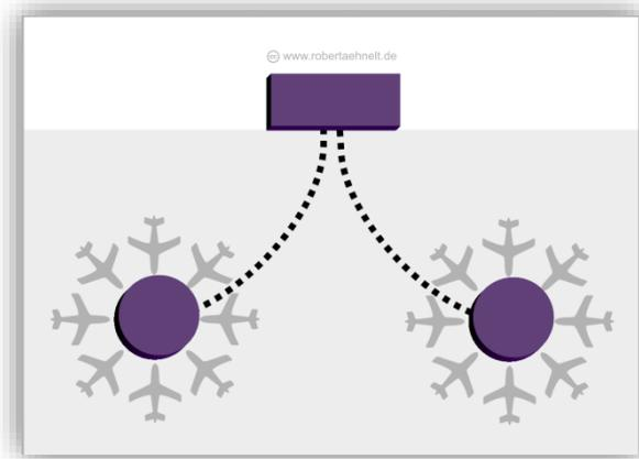
**Figure 66.** Schéma du concept de terminal à satellite
