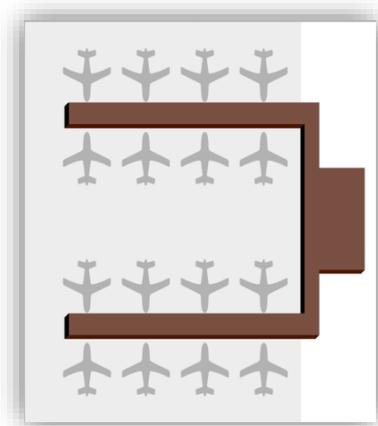
**Figure 65.** Schéma du concept de terminal à jetée
