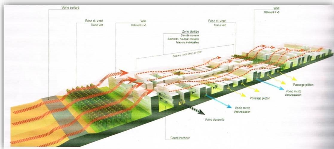
**Figure 19.** Schéma du système de protection de la ville nouvelle<sup>10</sup>
