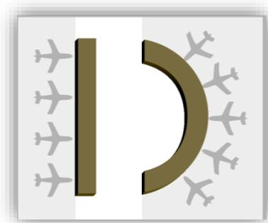
**Figure 64.** Schéma du concept de terminal linéaire
