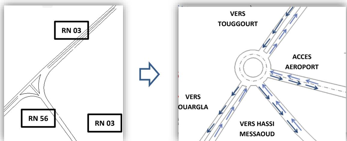
**Figure 79.** Schéma de la transformation du rond-point d'accès
