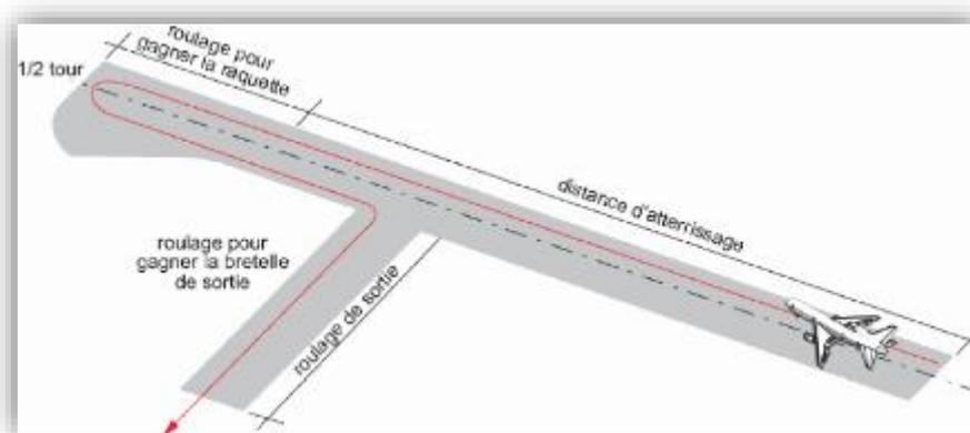
**Figure 67.** Schéma du circuit d'atterrissage des avions<sup>18</sup>
