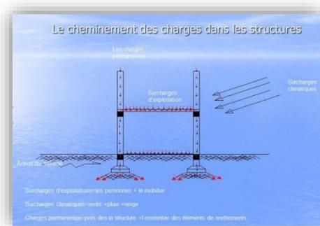
**Figure 6.** Schéma du cheminement des charges dans les structures<sup>4</sup>
