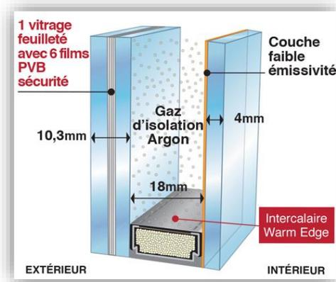
**Figure 101.** Schéma d'une disposition en double vitrage
