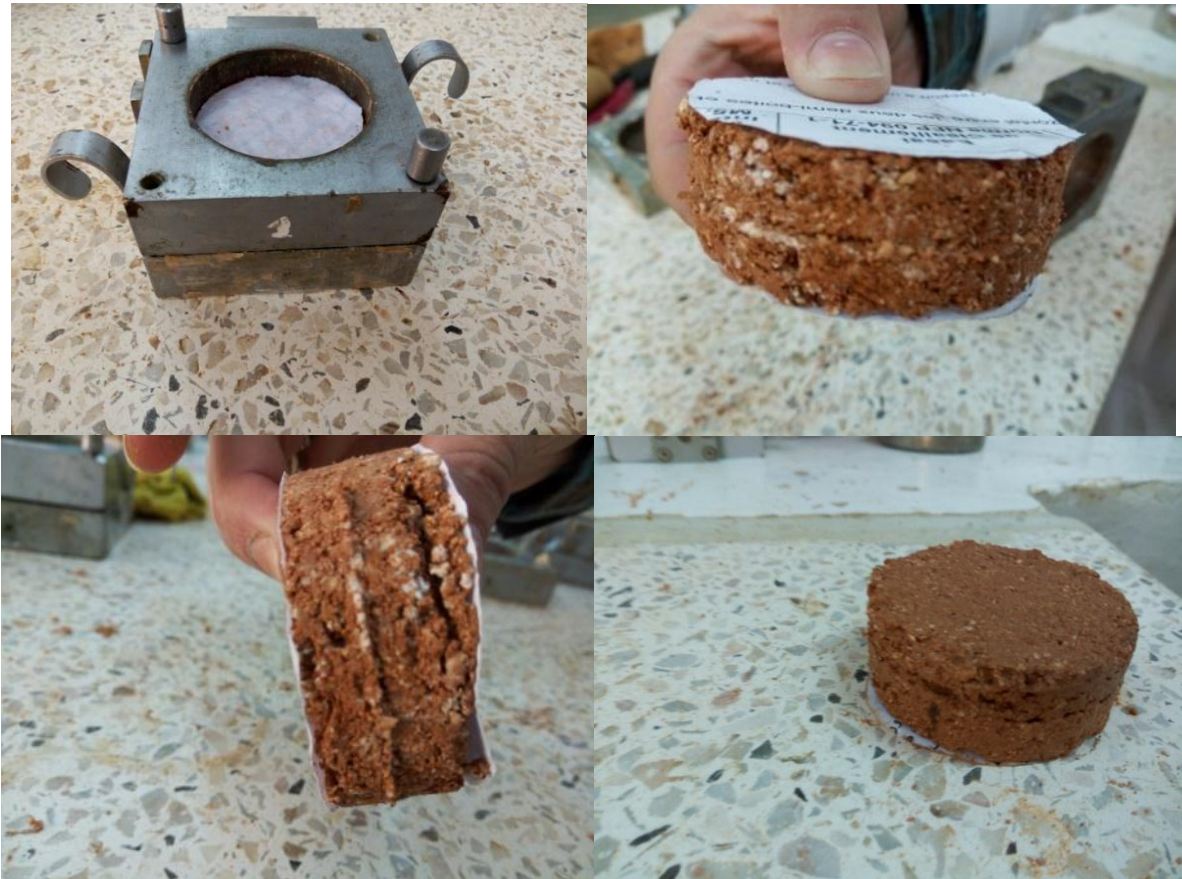
Figure 3.18 : Réalisation de l'essai de cisaillement cas du sol saturé ou non saturé.
