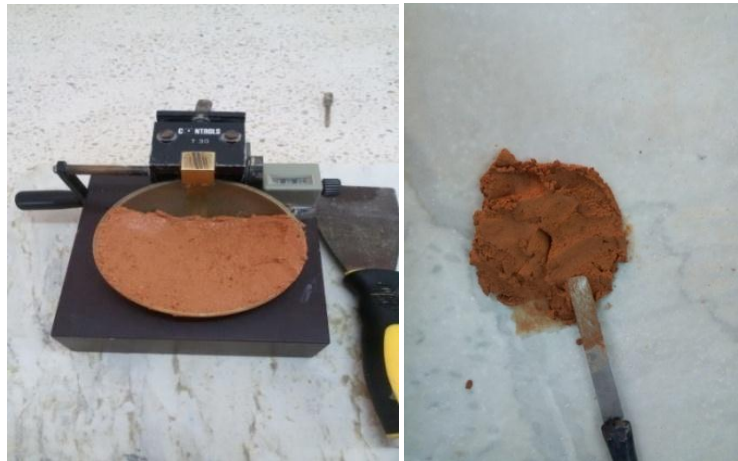
Figure 3.6 : Réalisation de l'essai de limite de liquidité.
