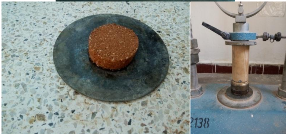
Figure 3.13 : Préparation des échantillons par compactage statique.
