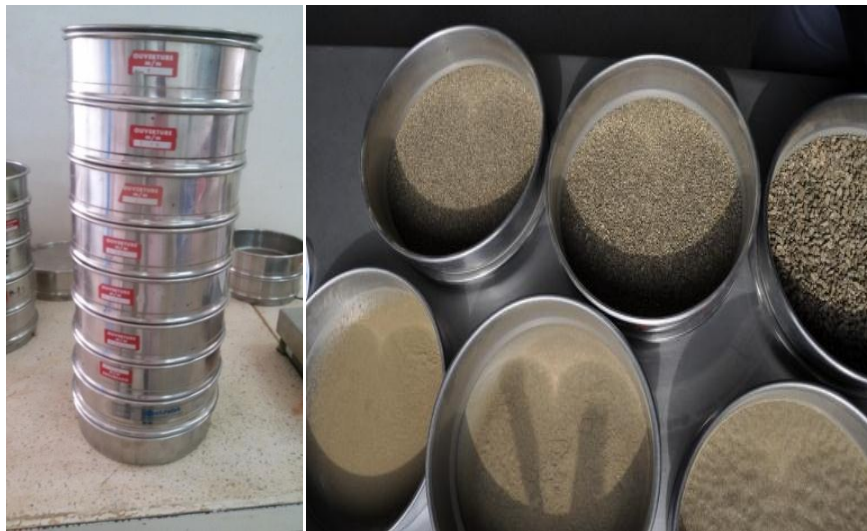
Figure 3.2 : Analyse granulométrique par tamisage.
