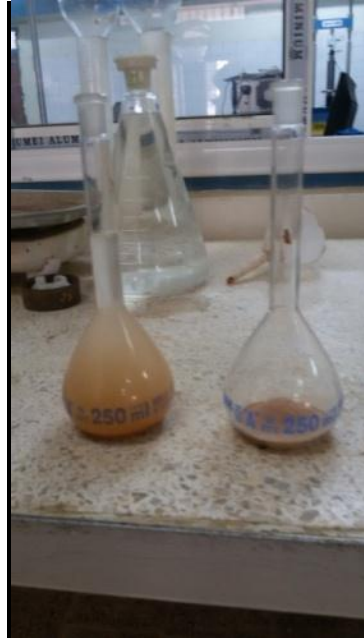
Figure 3.9 : Réalisation d'essai de Pycnomètre.
