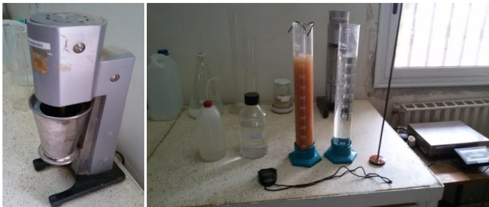
Figure 3.3 : Analyse granulométrique par sédimentation.
