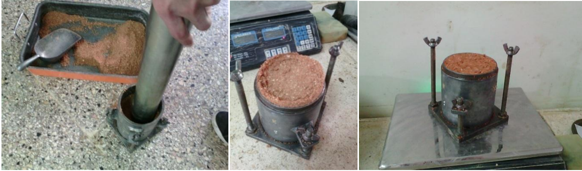
Figure 3.10 : Réalisation de l'essai de compactage.
