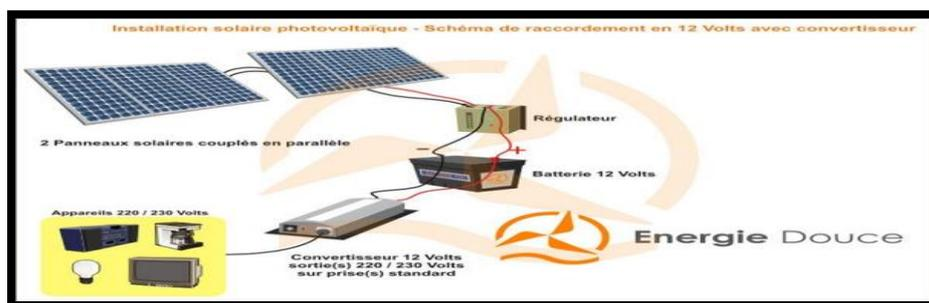
Figure217 : principe de fonctionnement d'un panneau photovoltaïque
