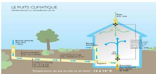
L'air puisé à l'extérieur passe dans des tuyaux enterrés entre 1 et 2 mètres de profondeur. A cette profondeur, la chaleur de la terre est constante toute l'année et se situe entre 13 et 17°
