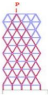
Figure 71 : Chemin des charges sous charges verticale
