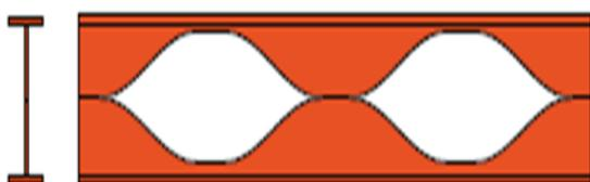
**Poutrelle alvéolaire a ouvertures sinusoidales**
