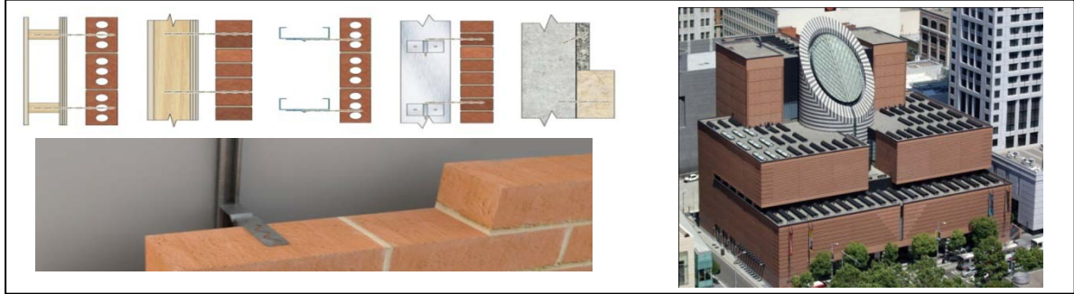
Figure n 10 : nouvelles attaches de maçonnerie
