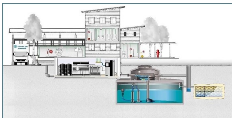
Figure 176 système de récupération des eaux pluviales
