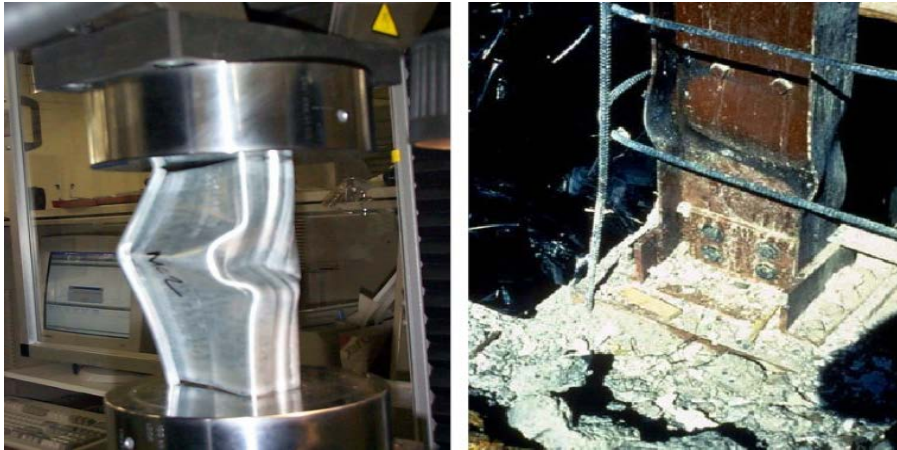
Image1.1 - Voilement local sur une poutre
