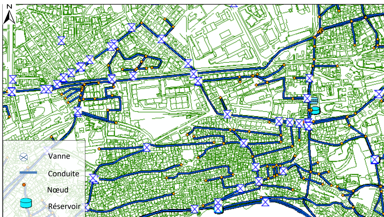
Figure IV.34 : Plan détaillé de la triangulation et de la codification des vannes
