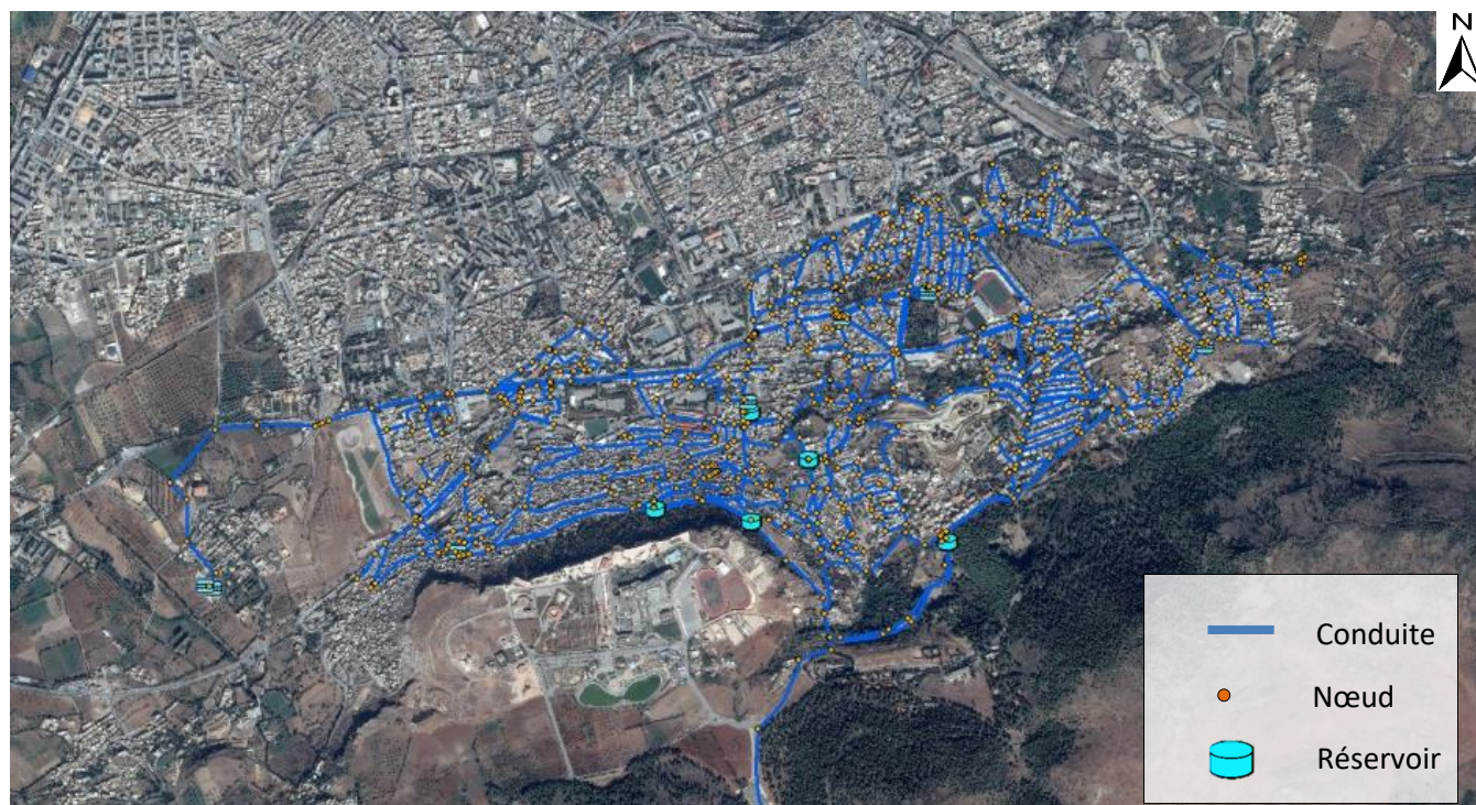
Figure IV.32: Plan du réseau et situation des réservoirs
