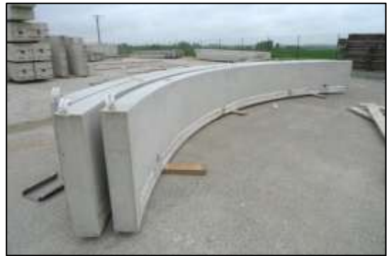
Photos 24 : mur préfabriqué en béton armé
